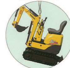
本機一点吊り
